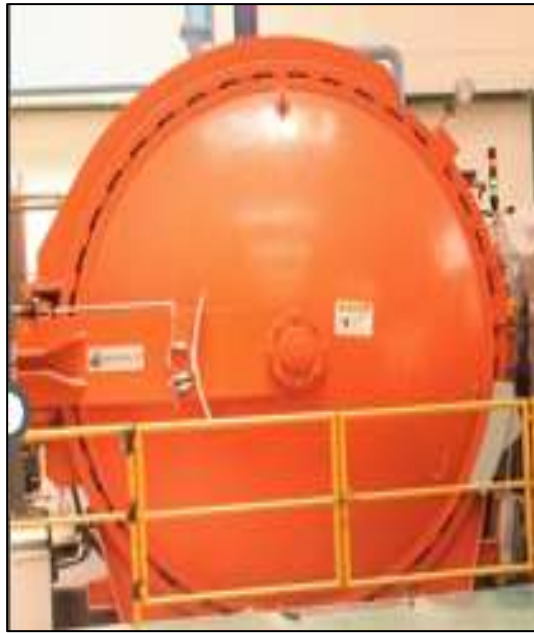
Dia 3m x 12m Autoclave
